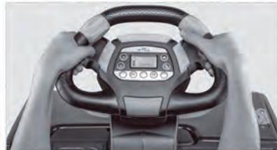
En los modelos EXH-S con acceso lateral de operador existe el volante STILL Easy Drive ajustable en altura, los operarios tanto diestros como zurdos pueden manejar todas las funciones de la carretilla mediante los elementos de control ergonómicos, sin necesidad de cambiar el agarre.
