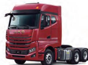
El nuevo integrante de la familia es el K7 490 6x2, modelo que estrena una nueva opción de tracción, manteniendo gran parte de las características de su hermano 6x4, como el PVB de 25.000 kilos y la capacidad de carga de 16.000 kilos además de su confiable motor Cummins ISG Euro V de 12 litros, que entrega 490 caballos de fuerza y 2.300 Nm de torque máximo desde las 1.100 revoluciones por minuto.
