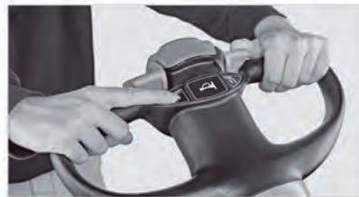
Operación intuitiva y ergonómica: los procesos de conducción, elevación y dirección pueden controlarse por operadores zurdos o diestros con una sola mano.
