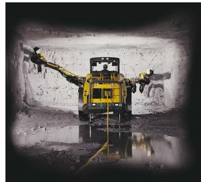
El modelo M2D es un equipo de última generación, que cuenta con altos estándares de seguridad, con el objeto de estar a la vanguardia de los requerimientos que exigen los trabajos en obras mineras, con cabinas cerradas y presurizadas, además de FOPS y ROPS. Adicionalmente, cuentan con un sistema de barrido semi húmedo dependiente de redes y sistema de engrase automático.
