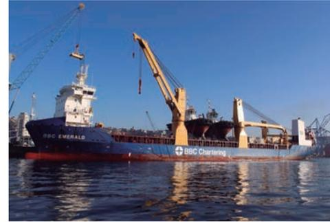
La operación de desembarco se realizará a través de un sistema tándem, lo cual permite descargar sólo un remolcador por día dado el peso de cada nave (405 toneladas) y así evitar la estabilización del buque que los transporta.
