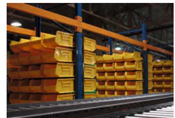
Y para el rubro Retail el proyecto consistió en la implementación de una línea de inducción para cajas plásticas que conecta la zona de picking a la zona de embalaje y despacho, esto es posible con un circuito de 150 metros de transportador motorizado aéreo logrando un rendimiento promedio de 1200 caja/hr.
