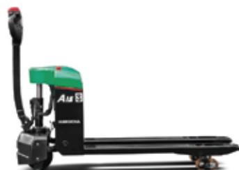
**Transpaleta eléctrica**, es la evolución de la manual. Los principios de funcionamiento son los mismos, pero tiene baterías y un motor eléctrico que impulsan las funciones de desplazamiento y elevación, lo que reduce el esfuerzo del operario y permite el traslado de cargas más pesadas.
