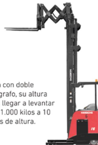
**Reach** con doble pantógrafo, su altura puede llegar a levantar hasta 1.000 kilos a 10 metros de altura.
