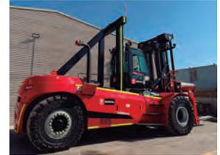
La grúa cuenta con un mástil doble que alcanza los 4 metros de altura y una cabina completamente suspendida de visión total (HCCS), pensada para mejorar la comodidad y seguridad del operador. Integra un motor diésel Tier 4F, que cumple con normativas de bajas emisiones, joystick de mando, sistema antivuelco y mayor estabilidad direccional. Además, viene equipada de fábrica con cámaras frontal y trasera, rejillas de protección, balizas y extintores.
